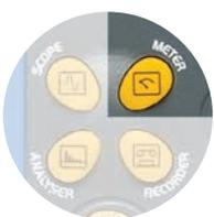
在四种“仪器”模式中，按一下图示对应的键，就进入了万用表模式。OX7000系列包含2或4通道TRMS数字万用表，可以测量幅值（AC和DC电压与电流，功率，热电偶等等），电阻，导通性，电容以及其它元器件。通过PT100到PT1000可测量温度（基于100和1000Ω电阻传感器）。为了尽可能的便利和高效，使用的所有类型的传感器都提供比例缩放和使用其物理单位。
