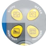
在输配电，电气工程和电力电子等行业，谐波分析对所有用户来说，是一个基本的功能。在基波频率介于40Hz和5KHz之间时，仪器可以显示信号的前61级谐波。仪器可同时显示2或4通道的谐波分析。
