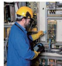
为机床的电子指挥控制单位进行测量
